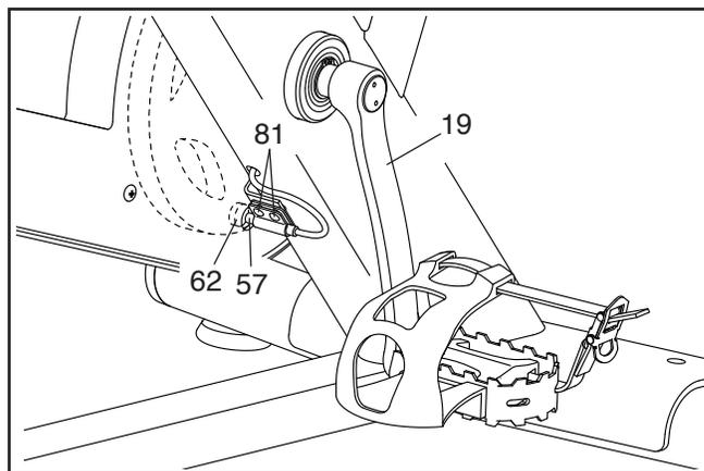
A continuación, gire el Brazo Izquierdo de la Manivela (19) hasta que un Imán (62) se alinee con el Interruptor de Lengüeta (57). Deslice el Interruptor de Lengüeta levemente hacia el Imán o en dirección opuesta a este. Luego, reapriete los Tornillos M4 x 16mm (81).
