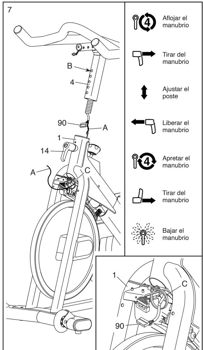
8. **Vea el diagrama incluido.** Conecte el conector del Cable de la Baranda (90) al conector del Cable de la Armadura (82). **Clave: Los conectores de los cables deben deslizarse juntos fácilmente y encajar en su lugar con un clic perceptible. Si no lo hacen, gire un conector y vuelva a intentarlo.**
