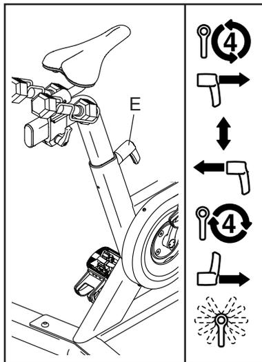
**apriete firmemente el manubrio de ajuste cuatro vueltas. Asegúrese de que el manubrio de ajuste esté enganchado en uno de los orificios de ajuste.** Luego, tire del manubrio de ajuste hacia fuera, gírelo para que apunte hacia abajo como se muestra y, a continuación, libérela.
