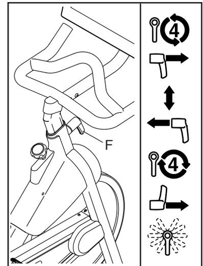
**Asegúrese de que el manubrio de ajuste esté enganchado en uno de los orificios de ajuste.** Luego, tire del manubrio de ajuste hacia fuera, gírelo para que apunte hacia abajo como se muestra y, a continuación, libérela.
