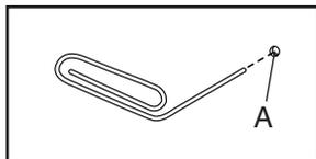
enchufe el adaptador de corriente. Siga manteniendo pulsado el botón de restablecimiento hasta que la consola se encienda. Al final del restablecimiento, la consola se apagará y se volverá a encender. Si no ocurre, desenchufe el adaptador de corriente y, luego, vuelva a enchufarlo. Una vez que la consola se encienda, busque actualizaciones de firmware (vea **CÓMO CAMBIAR LOS AJUSTES DE LA CONSOLA** en la página 26). Nota: La consola puede tardar unos minutos antes de estar lista para el uso.
