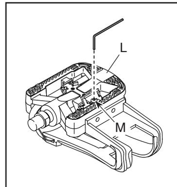
**Ajuste la tensión del muelle del otro pedal de la misma manera.**
