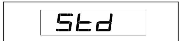
**Displayprüfung** – Dieser Bildschirm ist Wartungstechnikern zugeordnet, damit sie bestimmen können, ob das Display richtig funktioniert.
