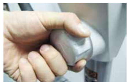
Mit dem Handrad kann der Widerstand während des Trainings verändert werden.
