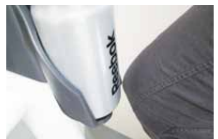
Eine Berührung der Flaschenhalterung ist wegen zu rutschigen Trittplächen möglich.
