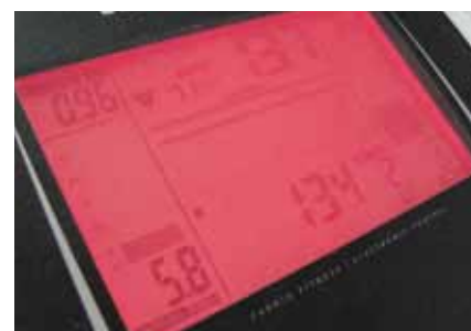
Bei Überschreitung des Maximalpulses färbt sich das Display rot.
