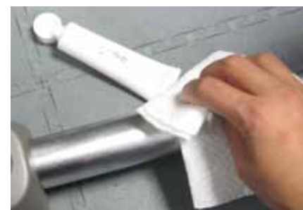
Die Oberseite der Gleitrolle sollte regelmäßig gereinigt und geschmiert werden.
