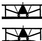
Auf unebenem Boden kann es sein, dass ein Fuß oder mehrere Füße nicht auflegen. Stellen Sie den Tisch an einem ebenen Ort auf oder sorgen Sie für Unterlagen unter den Füßen.
