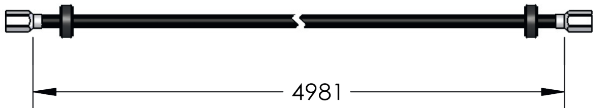
Schritt 18b: Seilzug für Bauchmodul/ Ab cable (873-500-002)
