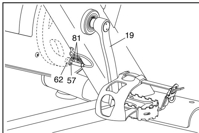
Als Nächstes drehen Sie den linken Kurbelarm (19), bis ein Magnet (62) auf den Reedschalter (57) ausgerichtet ist. Schieben Sie den Reedschalter leicht zum Magneten hin oder davon weg. Dann ziehen Sie die M4 x 16mm Schrauben (81) wieder fest.
