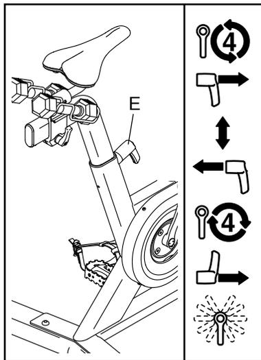
**mit vier Umdrehungen fest an. Vergewissern Sie sich, dass der Einstellgriff in einem Einstelloch eingerastet ist.** Dann ziehen Sie den Einstellgriff nach außen, drehen Sie ihn, sodass er nach unten zeigt, wie abgebildet, und lassen Sie ihn dann los.
