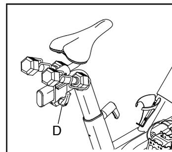
Hinweis: Der Trägergriff (D) funktioniert wie eine Ratsche. Drehen Sie den Trägergriff in die gewünschte Richtung, ziehen ihn nach außen, drehen ihn in die entgegengesetzte Richtung, drücken ihn nach innen und drehen ihn dann wieder in die gewünschte Richtung. Wiederholen Sie diesen Vorgang so oft wie nötig.
