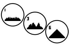
Drej fra "Hurtig start" mod højre. Derved kommer man til profiltræning 1 – 6. I profiltræning ændrer apparatet automatisk belastningen efter en fastlagt profil. I profilerne 1-3 ændres belastningen moderat, i profilerne 4-6 er ændringerne mere krævende. Når du har valgt en profiltræning, skal du vælge den tid, du vil træne i. Derefter kan du starte træningen.
