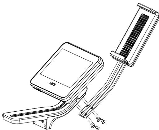
DE - Die Gummiabdeckung ist bereits vormontiert. Bitte entfernen Sie diese vor dem Verschrauben.
