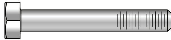
PERNO PLATEADO DE CABEZA HEXAGONAL M10 X 70 MM (CANT. 3)
