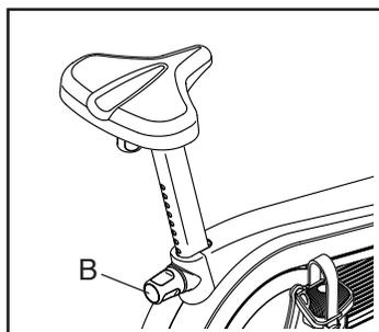
los. **Bewegen Sie die Sitzstütze leicht aufwärts oder abwärts, um sicherzustellen, dass der Knauf in einem der Einstelllöcher an der Sitzstütze eingearastet ist.** Dann ziehen Sie den Knauf fest.
