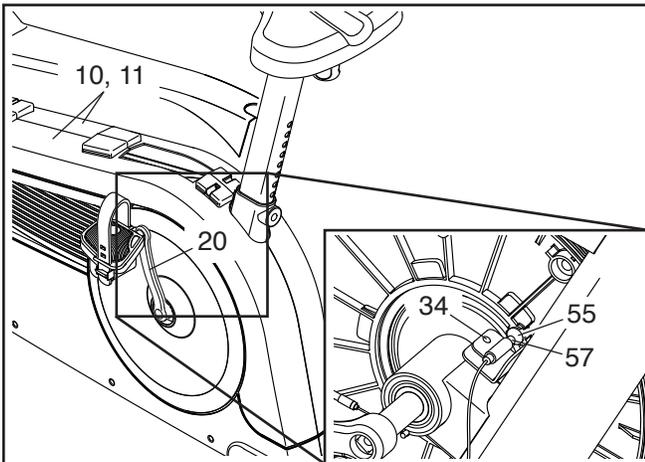
**Siehe die untere Abbildung links.** Ziehen Sie die Oberseiten der Schutze (10, 11) vorsichtig auseinander und finden Sie den Reedschalter (57). Drehen Sie den linken Kurbelarm (20), bis ein Magnet (55) mit dem Reedschalter ausgerichtet ist. Dann lockern Sie die M4 x 18mm Schraube (34) ein wenig, schieben Sie den Reedschalter leicht zum Magneten hin oder davon weg und ziehen Sie dann die Schraube wieder fest.
