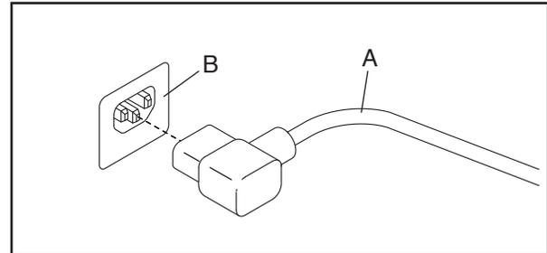
2. Inserire l'altra estremità del cavo di alimentazione (A) in una presa a muro adeguata (C), opportunamente installata e dotata di messa a terra in conformità con tutte le normative e i regolamenti locali.
