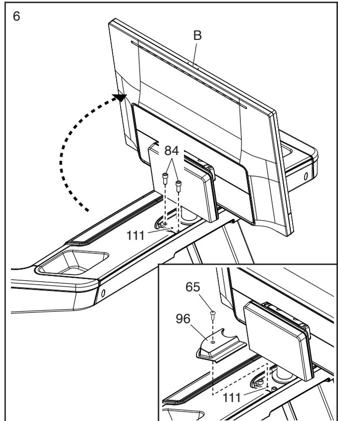
7. **Ruotare il gruppo consolle (B) per riportarlo nella posizione originale.** Serrare saldamente le Due Viti da 5/16" x 3/4" (84) fissate nella fase 5.
