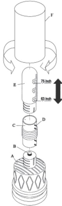
3. Befestigen Sie die Feder (C) mit acht Schrauben (D) an dem Standfuß (A).
