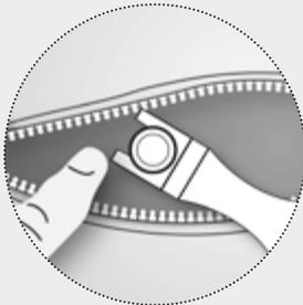
**ACHTUNG:** Der Ventilverschluss kann durch den Luftdruck plötzlich aus dem Ventilloch gepresst werden. Sichere diesen durch das Auflegen eines Fingers.
