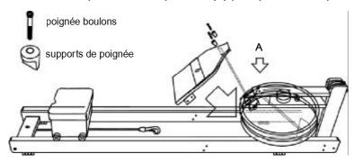
**CINQUIÈME ÉTAPE-** Insérez les écrous JCN et les vis JCB pour fixer le réservoir et le repose-pieds sur les rails en A et B. Les écrous doivent être placés à l'intérieur et les boulons à l'extérieur. Si vous avez un problème pour aligner les composants, desserrez toutes les fixations, alignez-les et resserrez-les.
