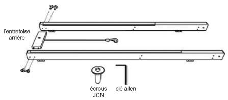
**DEUXIÈME ÉTAPE-** Posez le siège entre les rails. Notez l'orientation du siège avec le creux vers l'arrière. Il peut être nécessaire d'écarter légèrement les rails pour permettre au siège de se mettre en place.
