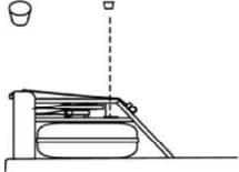
Insérez le bouchon (il peut être nécessaire d'humidifier le bouchon pour faciliter sa mise en place).
